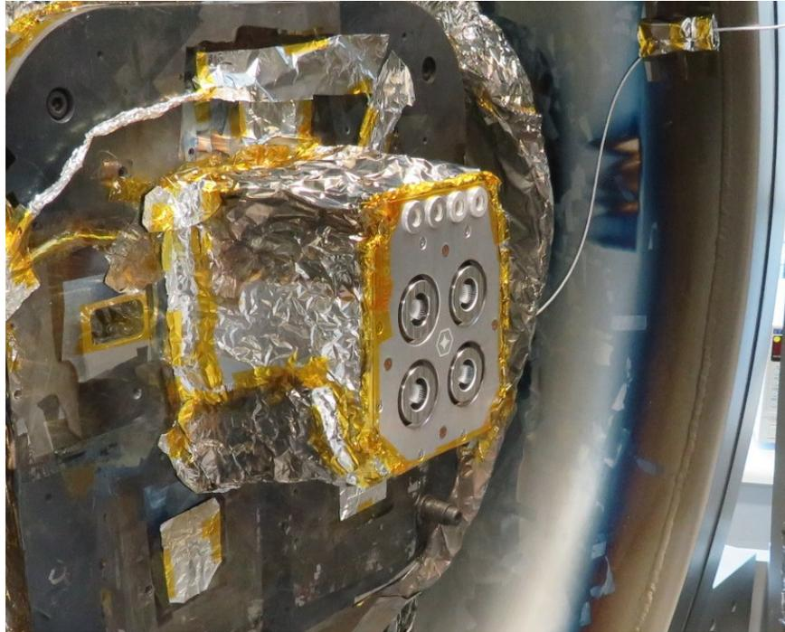
**Fig. 14 MICRO R<sup>3</sup> TVAC setup**
